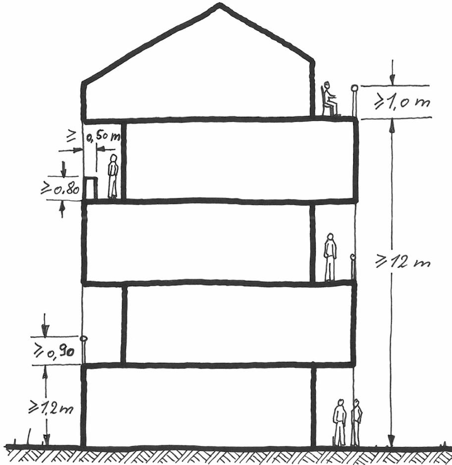
Figure 14 Géométrie des garde-corps (entraxe entre barreaux verticaux et dispositif empêchant d'y grimper)
